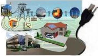
智能电网（smart power grids），就是电网的智能化，也被称为“电网2.0”，它是建立在集成的、高速双向通信网络的基础上，通过先进的传感和测量技术、先进的设备技术、先进的控制方法以及先进的决策支持系统技术的应用，实现电网的可靠、安全、经济、高效、环境友好和使用安全的目标，其主要特征包括自愈、激励和包括用户、抵御攻击、提供满足21世纪用户需求的电能质量、容许各种不同发电形式的接入、启动电力市场以及资产的优化高效运行。
