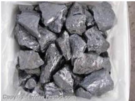
多晶硅，是单质硅的一种形态。熔融的单质硅在过冷条件下凝固时，硅原子以金刚石晶格形态排列成许多晶核，如这些晶核长成晶面取向不同的晶粒，则这些晶粒结合起来，就结晶成多晶硅。利用价值：从目前国际太阳能电池的发展过程可以看出其发展趋势为单晶硅、多晶硅、带状硅、薄膜材料（包括微晶硅基薄膜、化合物基薄膜及染料薄膜）。
