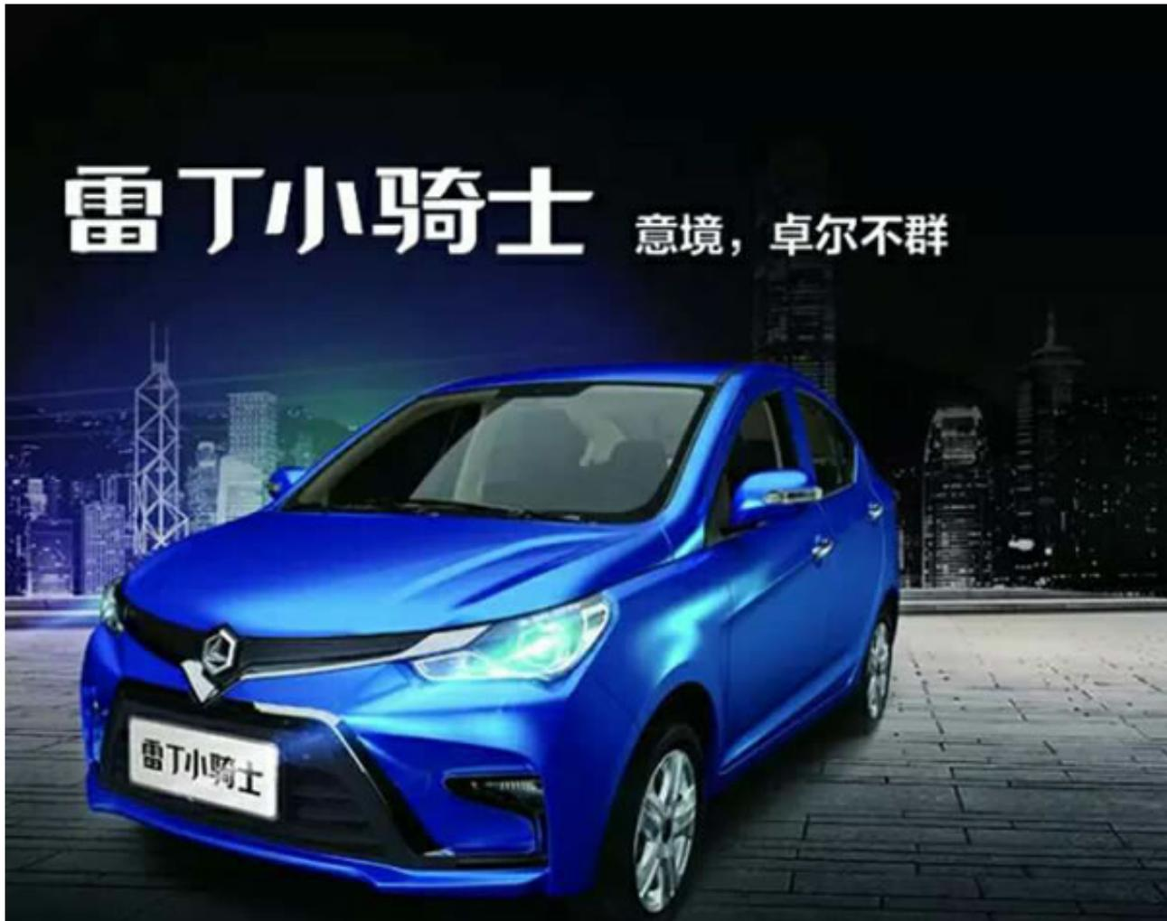
雷丁小骑士采用溜背三厢造型，其车身尺寸为4026/1618/1511mm，轴距为2400mm。外观方面，该车前脸采用大量镀铬装饰条，前大灯集成LED日间行车灯，保险杠下方配有雾灯，车尾配备鸭尾式尾翼和后保险杠扰流板，配备电动转向助力、GPS导航系统和U-Cari车载互联系统。
