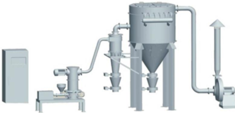
电子级材料专用流化床气流粉碎机
