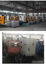
5. 粗磨工序加工，中心位置调整
