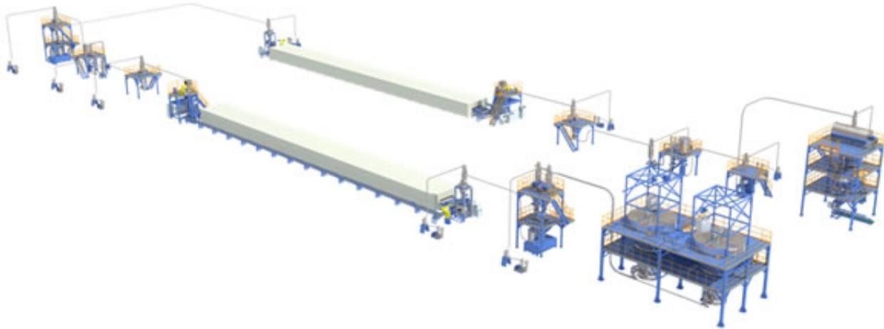
无锡灵鸽-锂电正负极材料制备系统
