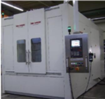
普诺迈（AMTS 2017 展位号：E1-B18）的T系列回转多工位去毛刺机针对复杂零件多部位去毛刺需要设计。采用干刷式去毛刺，PLC控制，整个过程完全自动，毛刷的工艺参数编程控制，自动补偿，各个工位工艺参数独立控制，工位采用回转方式，零件自转和转盘整体回转采用不同的电机控制，可以与夹具联动、形成多轴复杂轨迹，定点去除特定部位毛刺。设备整体安全防护及故障自诊断采用欧洲标准。
