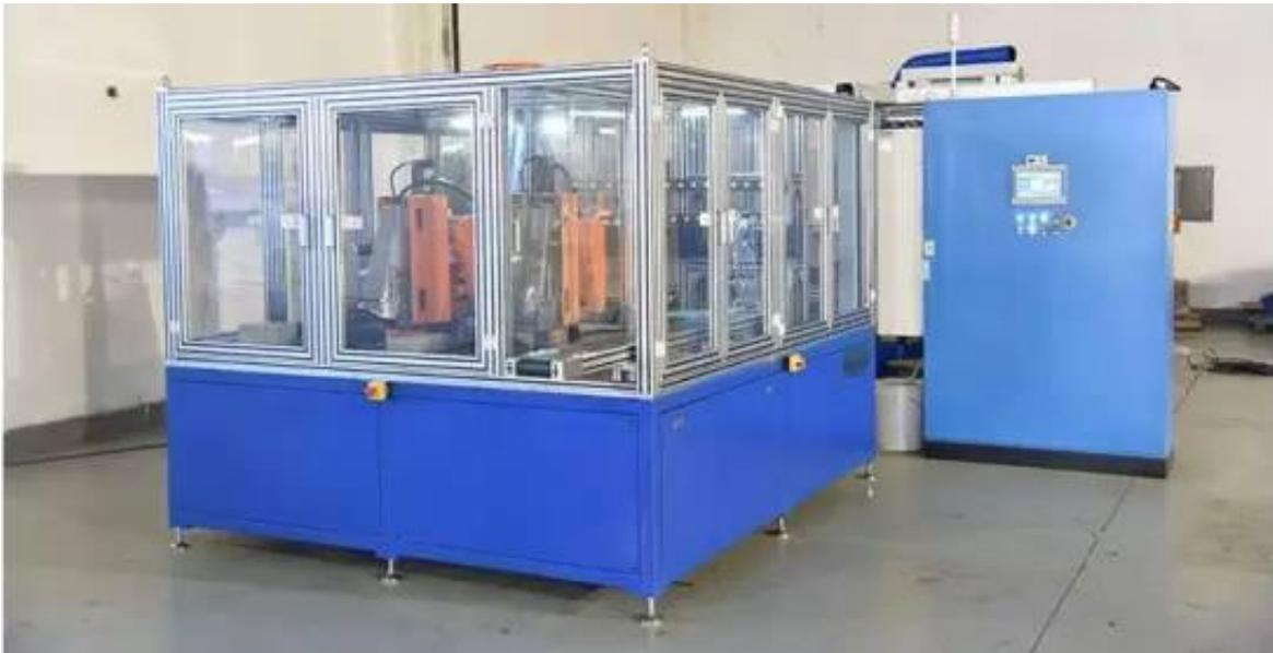
铭镭激光（AMTS 2017 展位号：E2-C24）将带来应用于金属表面除锈、表面除漆脱漆处理、表面镀层和涂层清除、焊接面/喷涂面预处理、石像表面灰尘及附着物清除、橡胶模具残留物清理以及表面油污、污渍、污垢清洗的ML-MF-200I-LC/ML-MF-500I-LC型设备。它是国内首款光纤高功率激光器激光清洗机，具有诸多优势：多种清洗模式可选，一键式智能操作；非接触式清洗，不损伤零件基体；精准清洗，可实现精确位置、精确尺寸选择性清洗；不需任何化学清洗液，无耗材，安全环保；操作简单，通电即可，可手持或配合机械手实现自动化清洗；清洗效率非常高，节省时间；激光清洗系统稳定，几乎无需维修。
