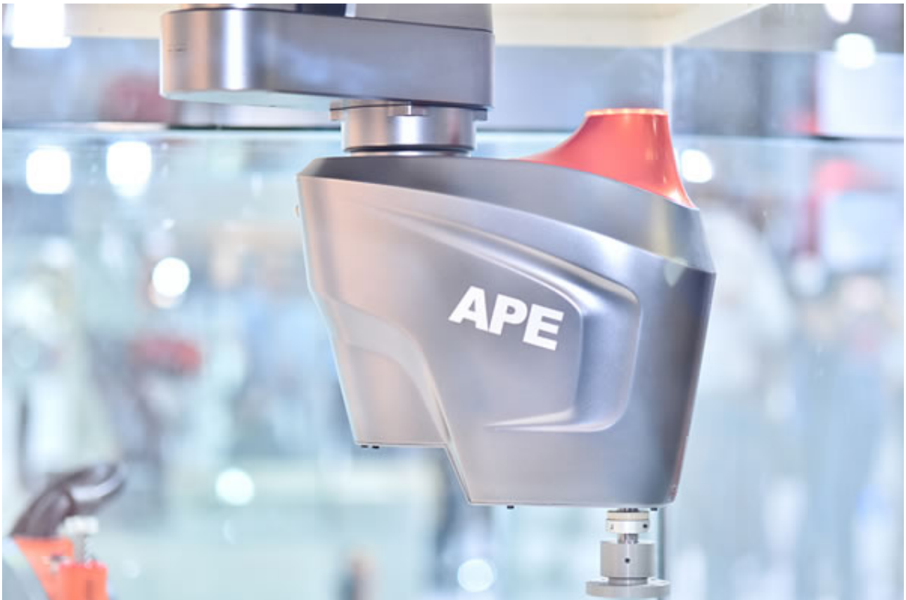
艾派（APE）公司展示了最小六轴机器人。自主开发的一款高精度机器人，精度达到0.5mm.适合三C电子产品智能制造。
