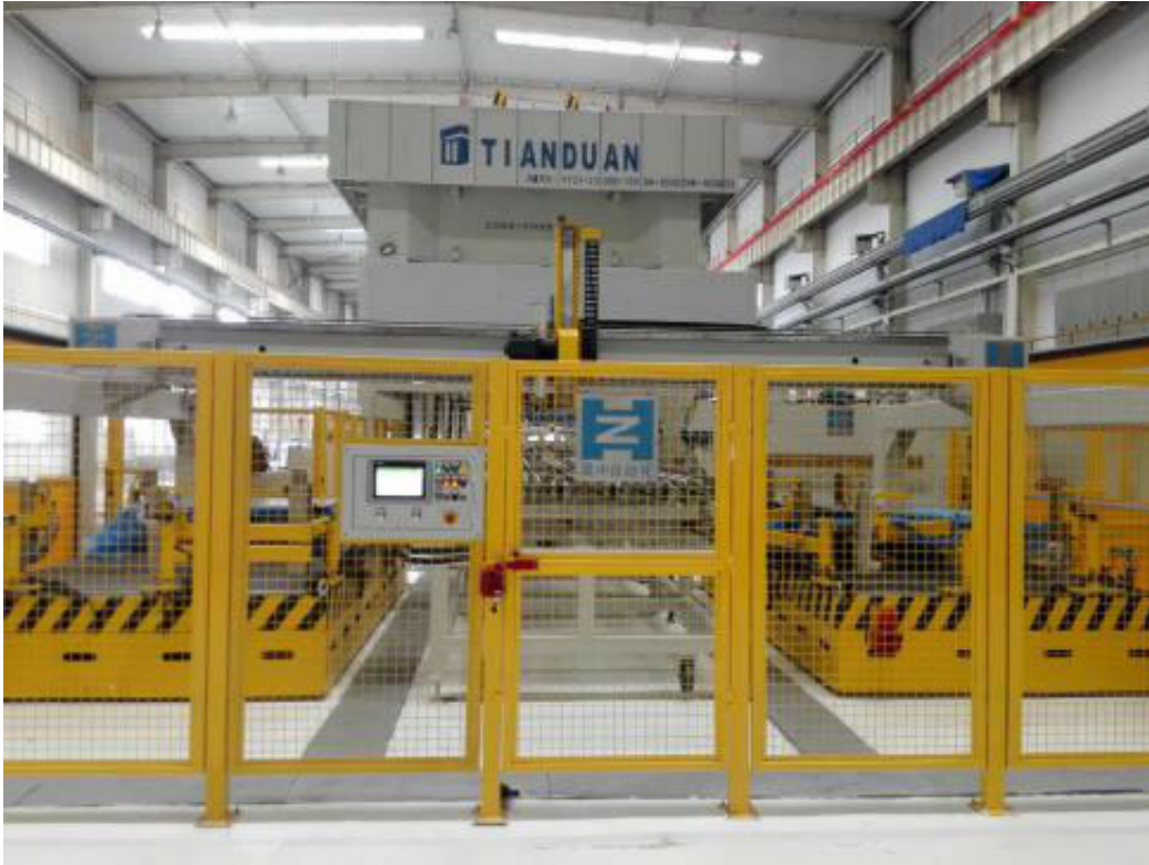
铝板拆垛系统-上海通用
