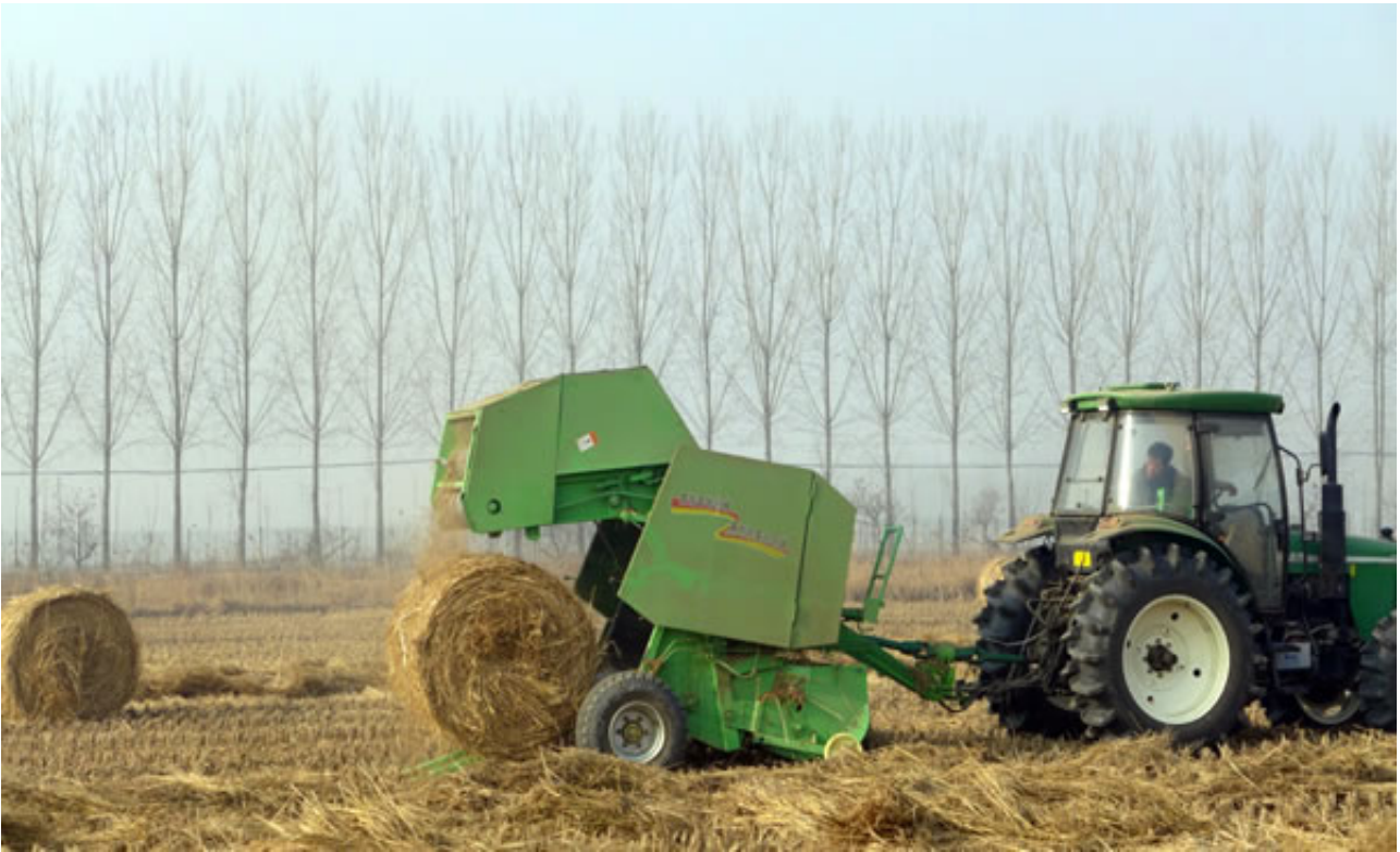
图为水稻秸秆打捆现场应用“梦创”圆捆9YG—1.3型打捆机，每小时可打水稻秸秆捆20捆，每捆重量约为230KG。
