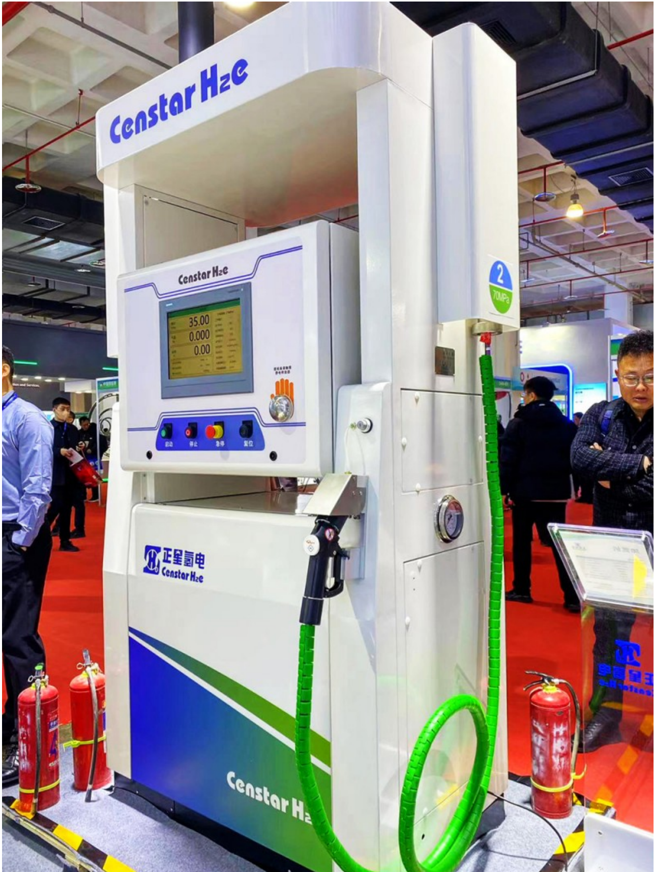
正星氢电PLC智能控制加氢机通过搭载全球先进的PLC控制技术，配备全面的安全联锁策略、友好的人机操作界面、简洁的控制显示面板，可实现加氢机的全自动“一键”加注操作。同时，该机型实现了同一气源两种压力（35MPa/70MPa）氢气加注，最大加氢流量7.2kg/min。能够满足乘用车最快5分钟加满、大巴车最快15分钟加满、重卡最快20
