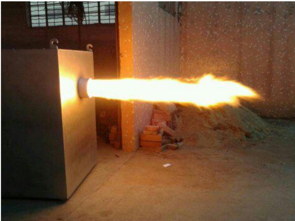
针对传统直烧式燃烧机的缺陷，佛山衢通机械有限公司研发了一款生物质气化燃烧机，此款燃烧机因是把燃料先在燃烧室进行中温气化，然后喷出可燃气体加以助氧燃烧，从而达到燃烧室中温、低压、喷出无灰削的高温火焰。另外，佛山衢通机械有限公司的这款生物质气化燃烧机具有省料、少灰、寿命长、省心、易操作等优点。欲知更多详情请莅临「Bioenergy China国际生物质会展」现场。
