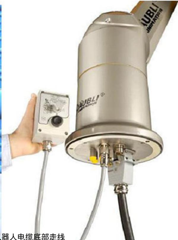
St ä ubli TX HE 机器人电缆底部走线
