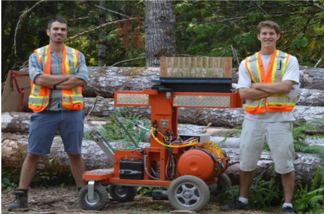
功夫不负有心人，他们的Tree Rover 种树机器人也在这四个月里孕育成功。机器人采用四轮电动驱动，可以再可以在设定的距离里自动种下一棵树苗。挖坑、种树、压板拍打，几秒钟时间，一棵树苗就这样种好了。
