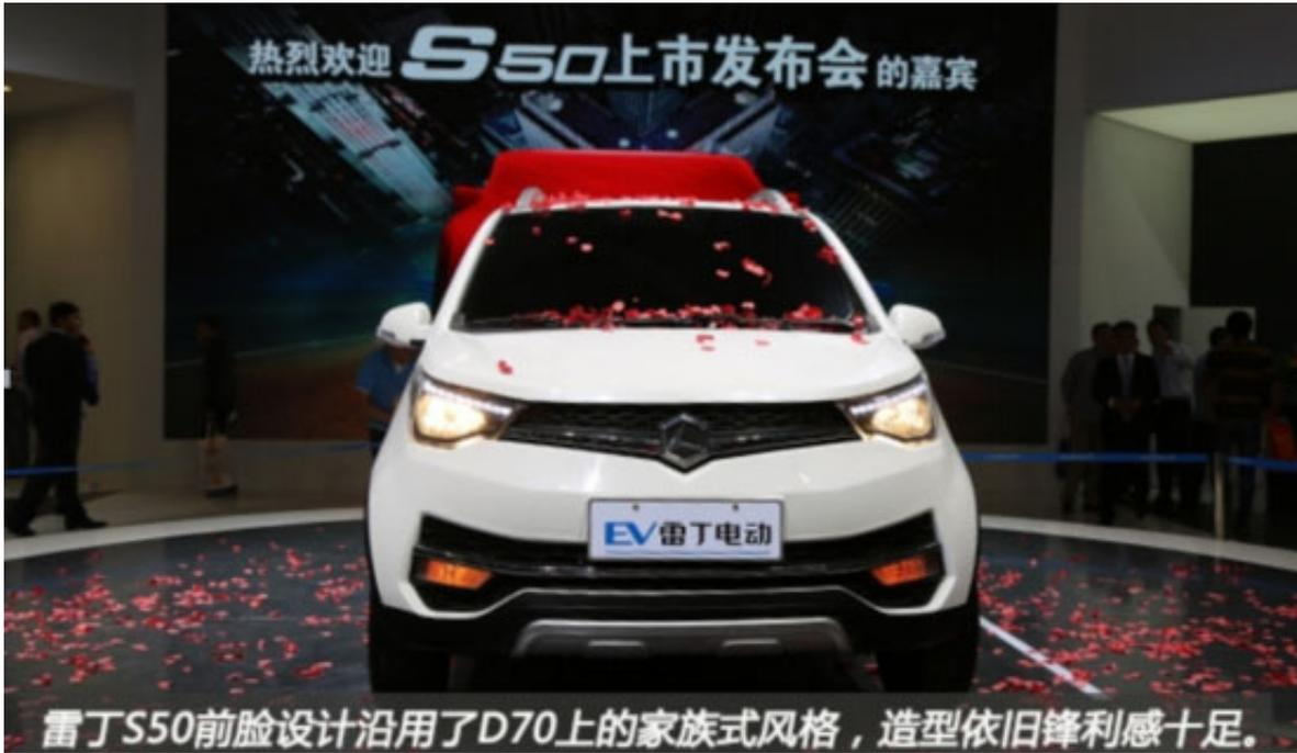
雷丁S50，是一款SUV，也是一款锂电混动版车型，采用了i-MMD双擎锂电混动技术，能够实现纯电模式和混动模式的智能切换。该车搭载了7.5KW HPS高速永磁同步电机驱动系统，采用电动SUV底盘调校技术，满载离地间隙150mm，通过性更强，能够轻松应对复杂路况。
