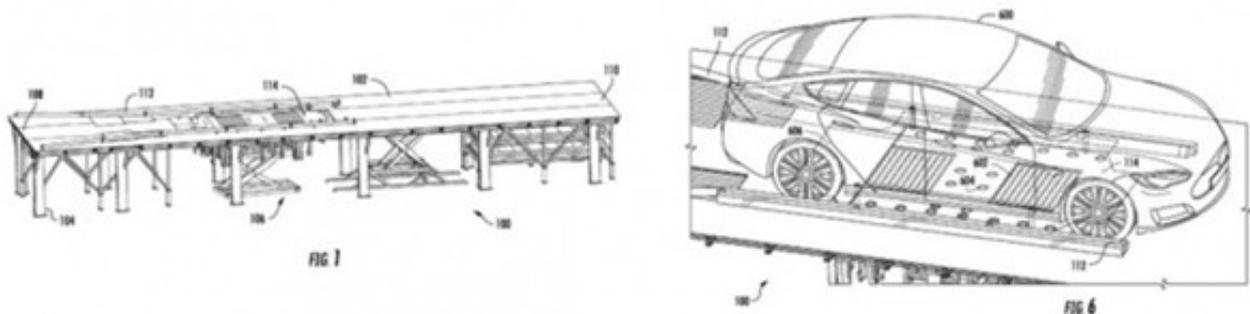
随后，换电装置会逐渐升起，把定位销和拆卸工具插入，卸下连接件，电池组即可脱离底盘，被卸下的电池组则会被拿去充电。至于新电池组的安装，则和拆卸电池组的工序相反。
