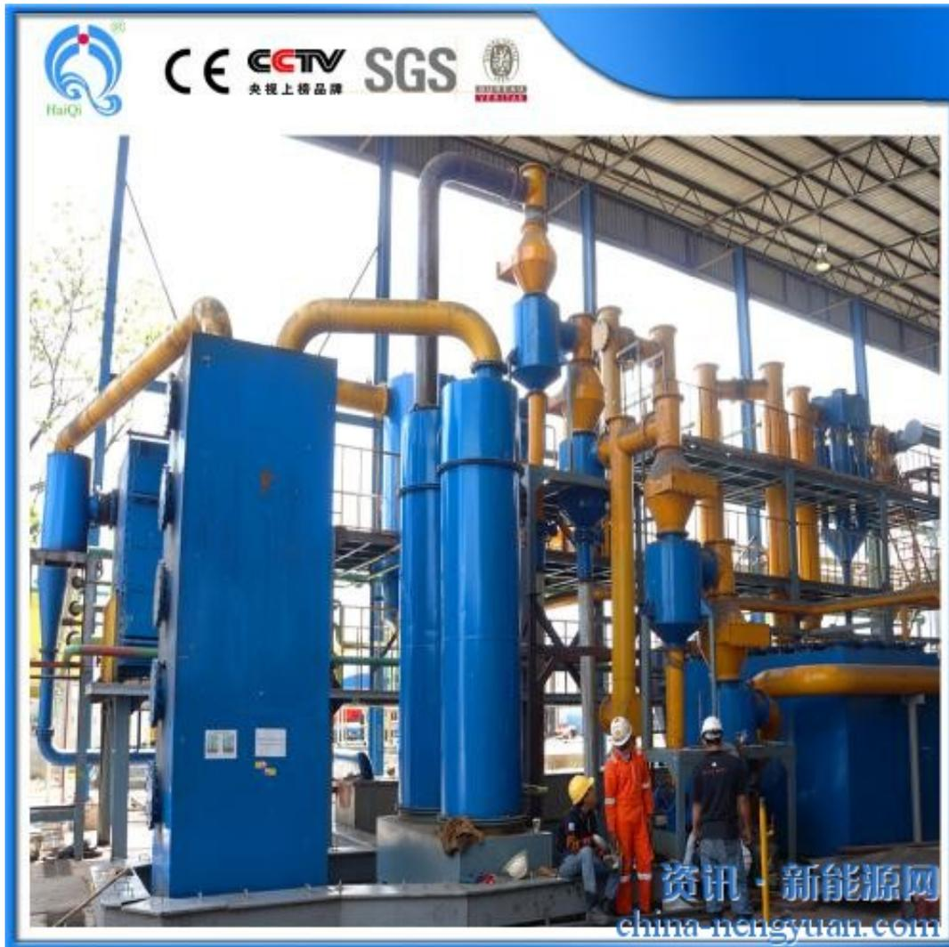
生物质气化发电技术的基本原理是把生物质转化为可燃气，再利用可燃气推动燃气发电设备进行发电。它既能解决生物质难于燃用而又分布分散的缺点，又可以充分发挥燃气发电技术设备紧凑而污染少的优点，所以是生物质能最有效最洁净的利用方法之一。
