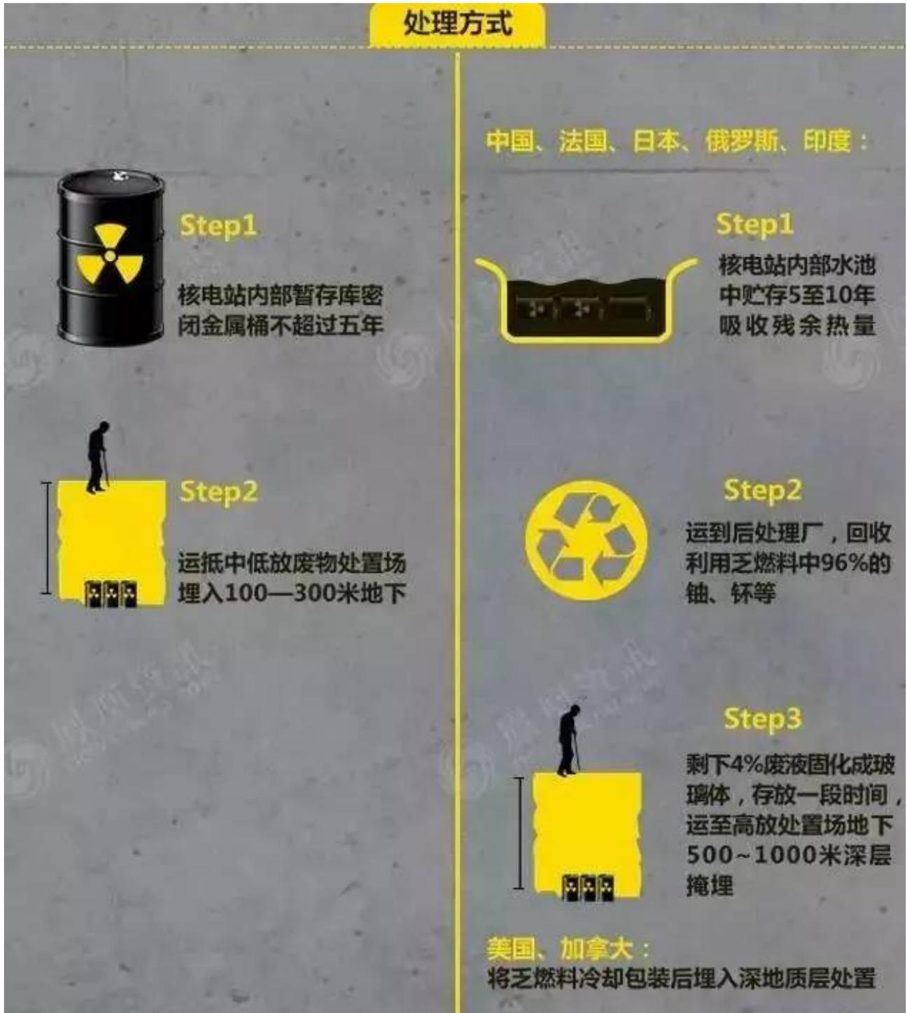
比如处置设施里面会有岩石、粘土，还有回填材料，还有十几、几十厘米厚的抗腐蚀金属容器，还有废物装载容器，还有废物自己的包壳或特殊形态（玻璃体）保护等等。——牢靠的很！几乎是目前能想到的最稳妥可靠的方法。
