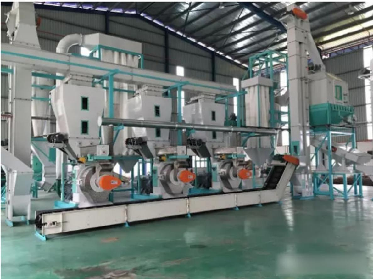
国外安装的5T生物质颗粒生产线
