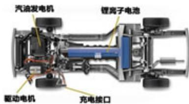
PHEV—有发动机，有动力电池，可电驱动，可充电
