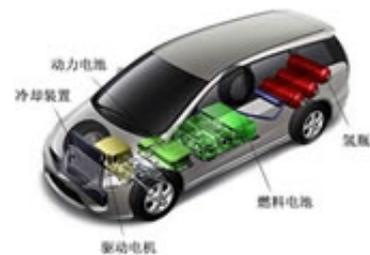
FCEV—没有发动机，有动力电池，有氢气瓶，电驱动，不可充电
