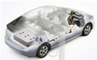
BEV—没有发动机，有动力电池，可电驱动，可充电
