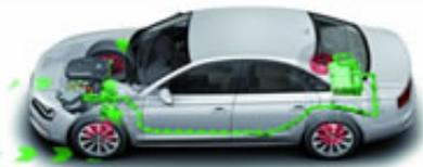
HEV—有发动机，有动力电池，可电驱动，但不可充电
