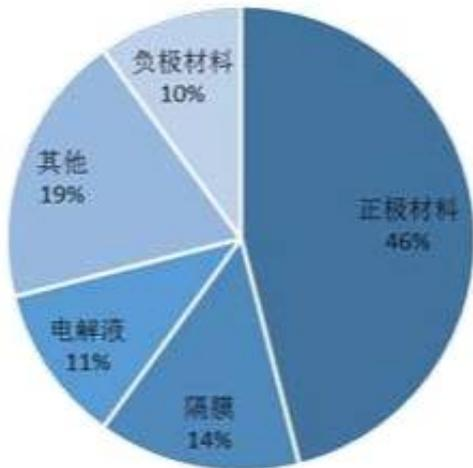
有一点是肯定的，正极材料是锂电池最核心和最贵的部分，他可以说是影响锂电池能量密度和性能的核心材料，成本占了30%--40%。目前四大核心原材料，除了隔膜目前国产化率较低，其他三个都已经实现了自主国产化。
