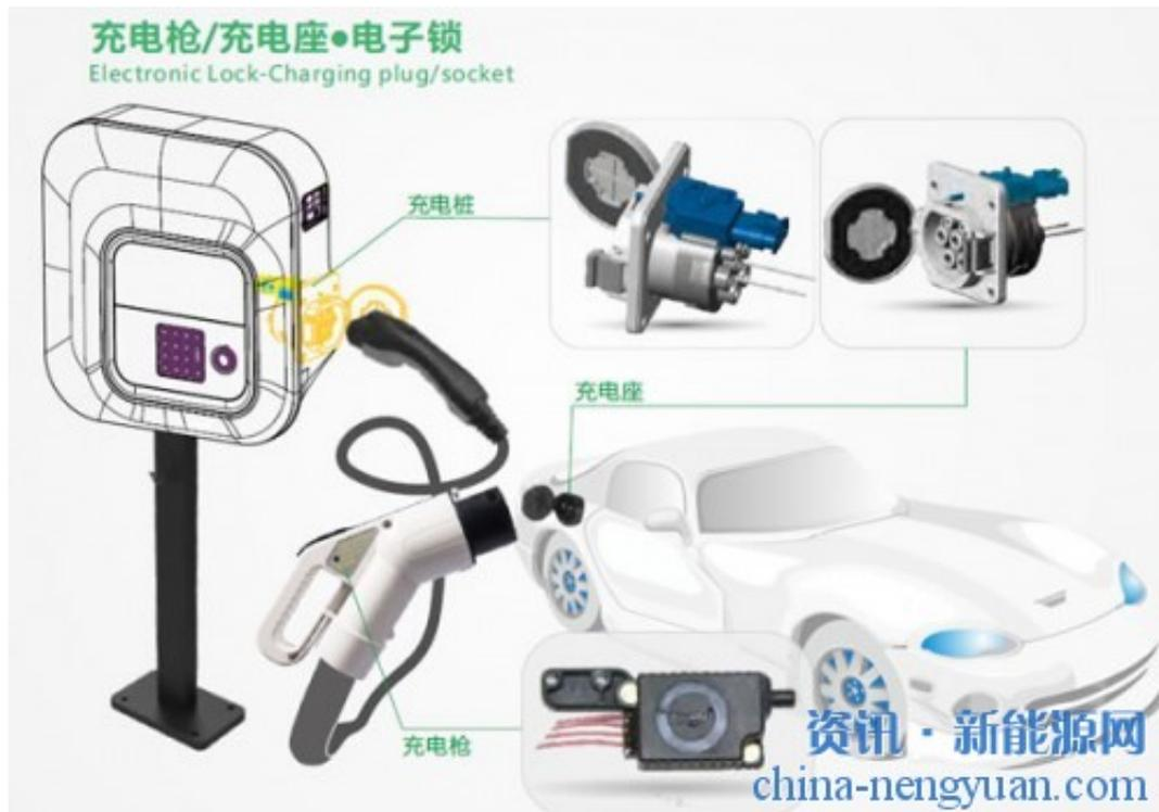
充电枪电子锁；对充电时的充电枪锁定，防脱落，松动；（在于充电枪使用次数过100次后，连接汽车有松动间隙，需手托住）；用电子锁后，当电子锁 锁定后才会计费，可防松动没冲到电，也在计费，锁定后，充电枪无需手托，无限使用次数防松动，同时电子锁也成为计费触点，当电子锁，解锁时，停止计费，电源断开，以及车载系统精确感应电子锁断开判定通电完成；可防触电。实现刷卡用户刷卡后无人值守自动化充电；无需专业人员操作。
