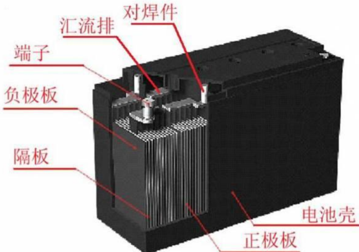
铅酸电池结构图（图片来源于网络）
