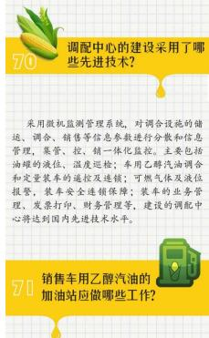
采用微机监测管理系统,对调合设施的储运、调合、销售等信息参数进行分散和信息管理,集管、控、报、销一体化监控。主要包括油罐的液位、温度巡检;车用乙醇汽油调合和定量装车的遥控及连锁;可燃液体及液位报警,装车安全连锁保障;装车的业务管理、发票打印、财务管理保障,建设的调配中心将达到国内先进技术水平。
