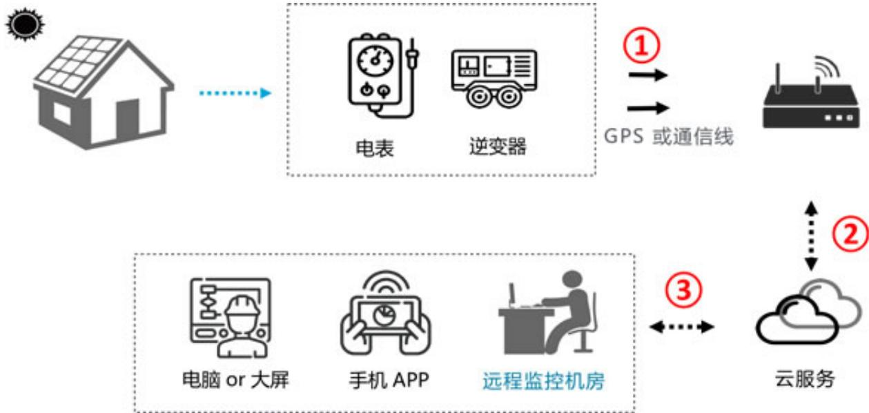
Ruff 采集器连接电表和逆变器，通过电表获取电站实时发电数据，通过逆变器监控电站实时运行状态；
