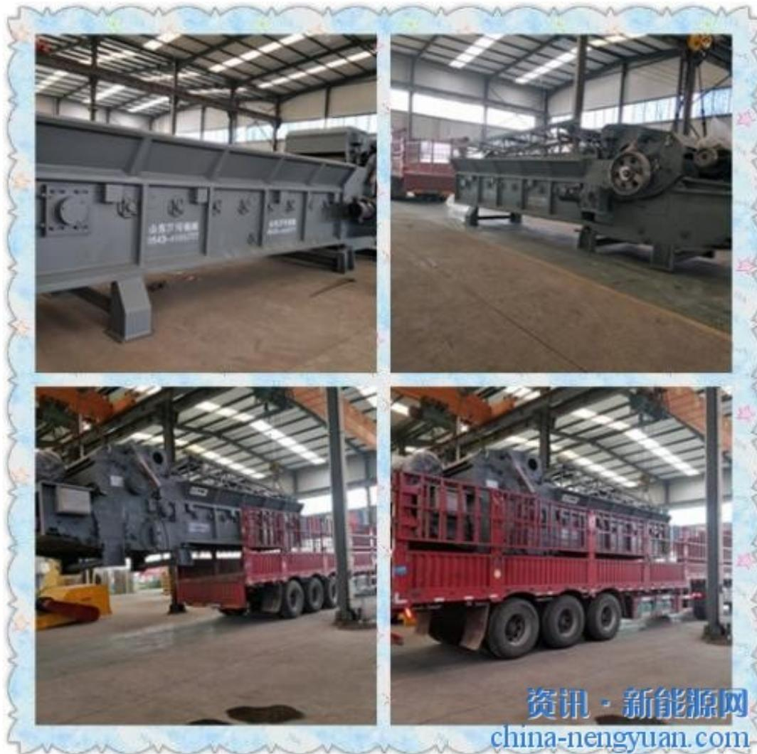
本机型加工原料广泛，（部署方便灵活）可加工木材如各类小径木、板皮、板条、圆木芯、建筑模板等，以及各种非木质原料如各种散装秸秆、棉柴、芦苇等，适用范围广。本机采用链板式智能进料，可以根据主电机负荷自动调节进料速度。使机器满负荷运转避免空载运行，使进料更加顺畅，大幅度提高生产能力，是生物发电厂的理想设备。
