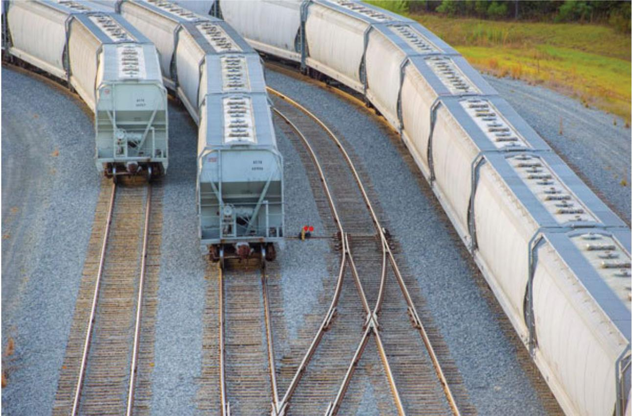
离开Morehouse生物能源公司的列车是稍微经过修改的封闭式谷物车，而不是敞顶式运煤车，以保护颗粒避免受到污染。Wedblad说：“这些车箱的每个设计承载能力是286,000磅（约129.7吨）。但由于当地桥梁和沿线路段的重量限制，我们每节车仅限于运送263,000磅（约119.3吨）。这仍然是很多颗粒。”
