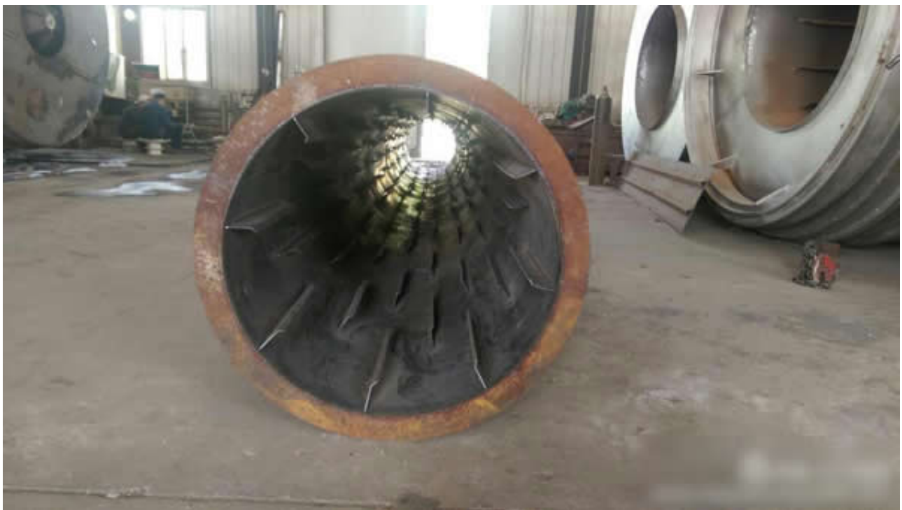
烘干机，三层滚筒的最中间的一层。有抄板。
