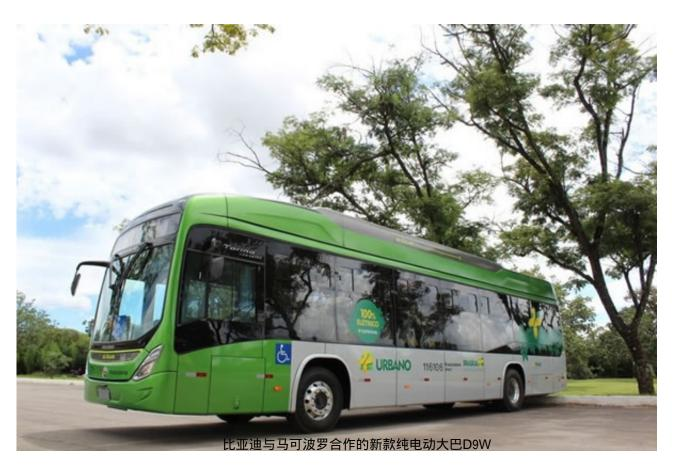
D9W是比亚迪巴西坎皮纳斯工厂100%电动大巴底盘和马可波罗Torino车身完美结合的产物。整车车长13.2m,作为一款零污染,零排放,续航高达300km的纯电动大巴,该车采用低地板设计,匹配气动前后悬挂,大大提高了整车的舒适性和通过性能,带给司机与乘客非凡的驾乘体验。与普通柴油大巴相比,比亚迪D9W纯电动大巴还具有维护成本低的优势,同时为减少当地大气污染和温室气体排放提供了解决方案,比亚迪D9W纯电动大巴同巴西利亚每个月平均运营近6000公里的新型欧五柴油大巴相比,每台D9W每年可减少近1.8吨以上的二氧化碳排放,这意味着相当于每年种植超过11棵树木。此外,每台运行的比亚迪纯电动大巴还可减少118,814公斤氮氧化物和1,152公斤颗粒物质(PM)的排放。
