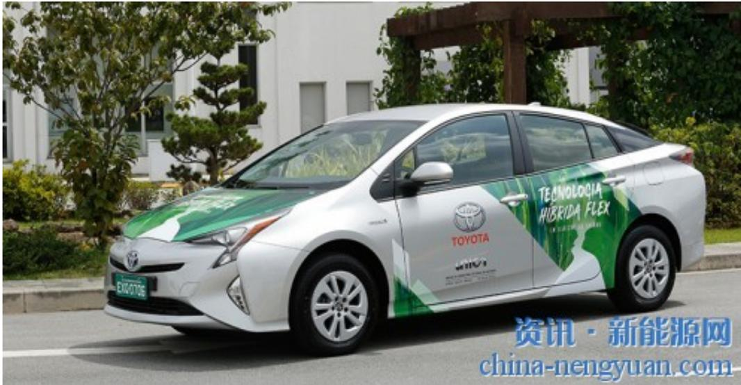
日本汽车制造商丰田汽车公司在巴西圣保罗举行的一次活动上首次推出了全球首款混合动力FFV汽车（Hybrid FFV）的样机。该原型是汽油和乙醇共同驱动的柔性燃料系统（FFV）以及由内燃机和电动动力总成相结合的丰田混合动力传动系统的组合。
