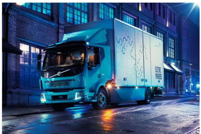
FL Electric将使用一台175马力输出功率(短时间的最高输出功率可以达到248马力)、313英尺·磅扭矩的电动引擎。另外它还将搭配2到6个锂离子电池,净容量则在100kWh到300kWh之间。如果使用的是6个锂离子电池套装,卡车的续航里程能够达到186英里(约为300公里)。
