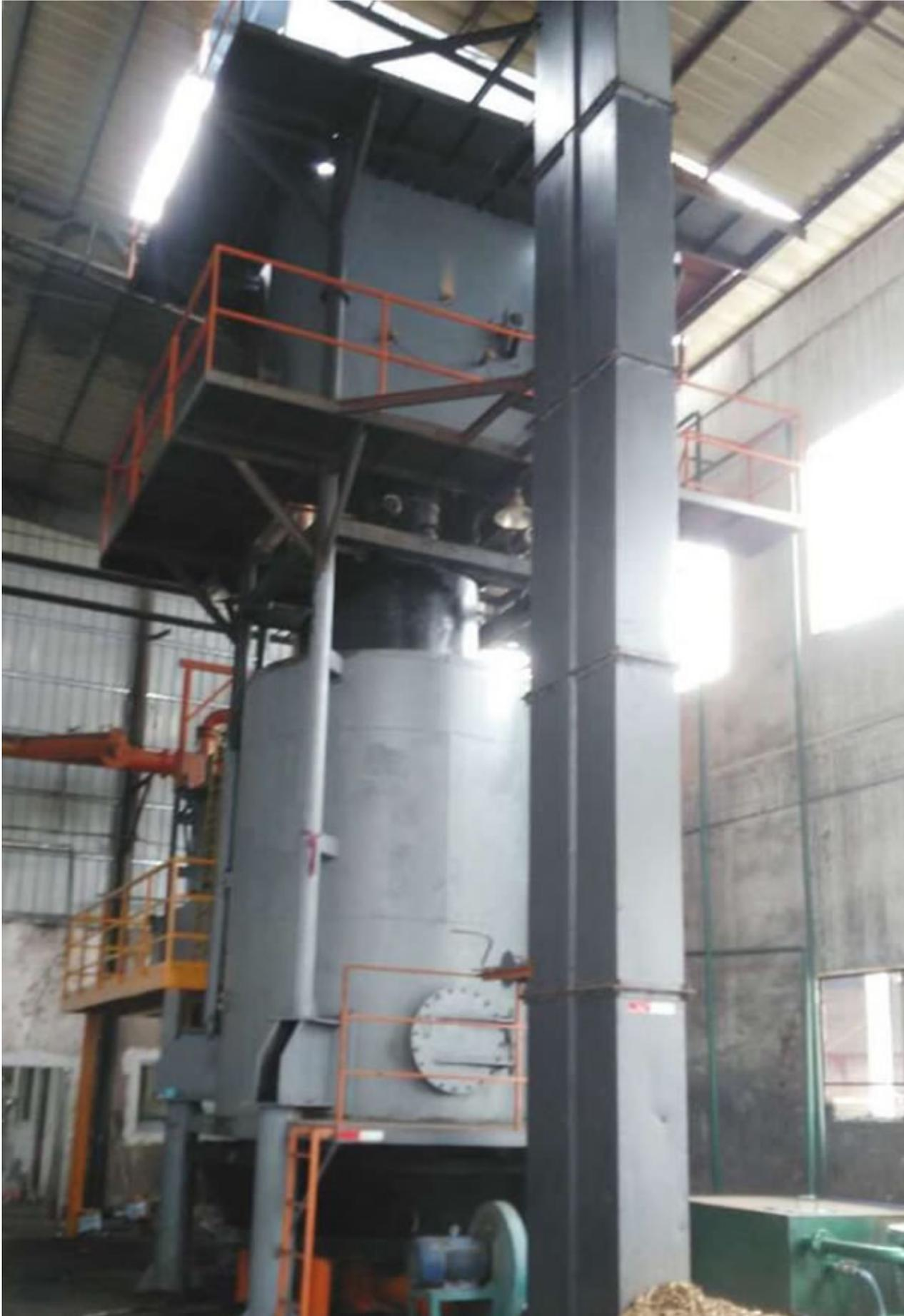
3.8吨气化炉，应用于新建8吨蒸汽锅炉
