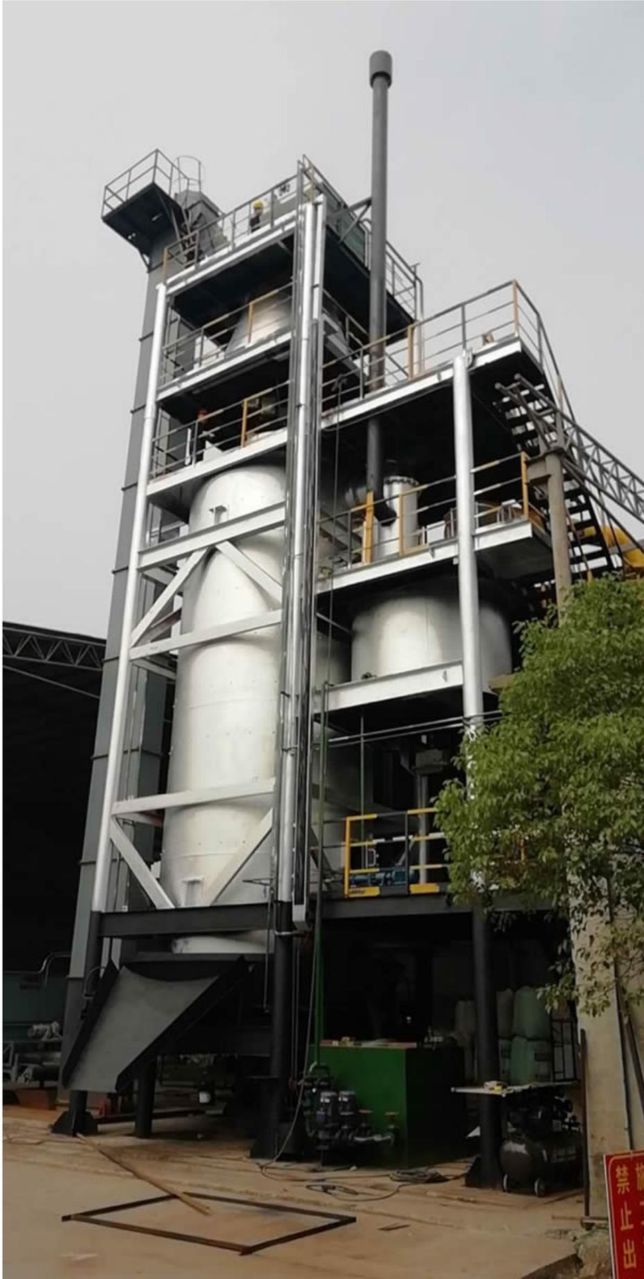
7、20吨气化炉用于10吨蒸汽锅炉和10吨导热油锅炉
