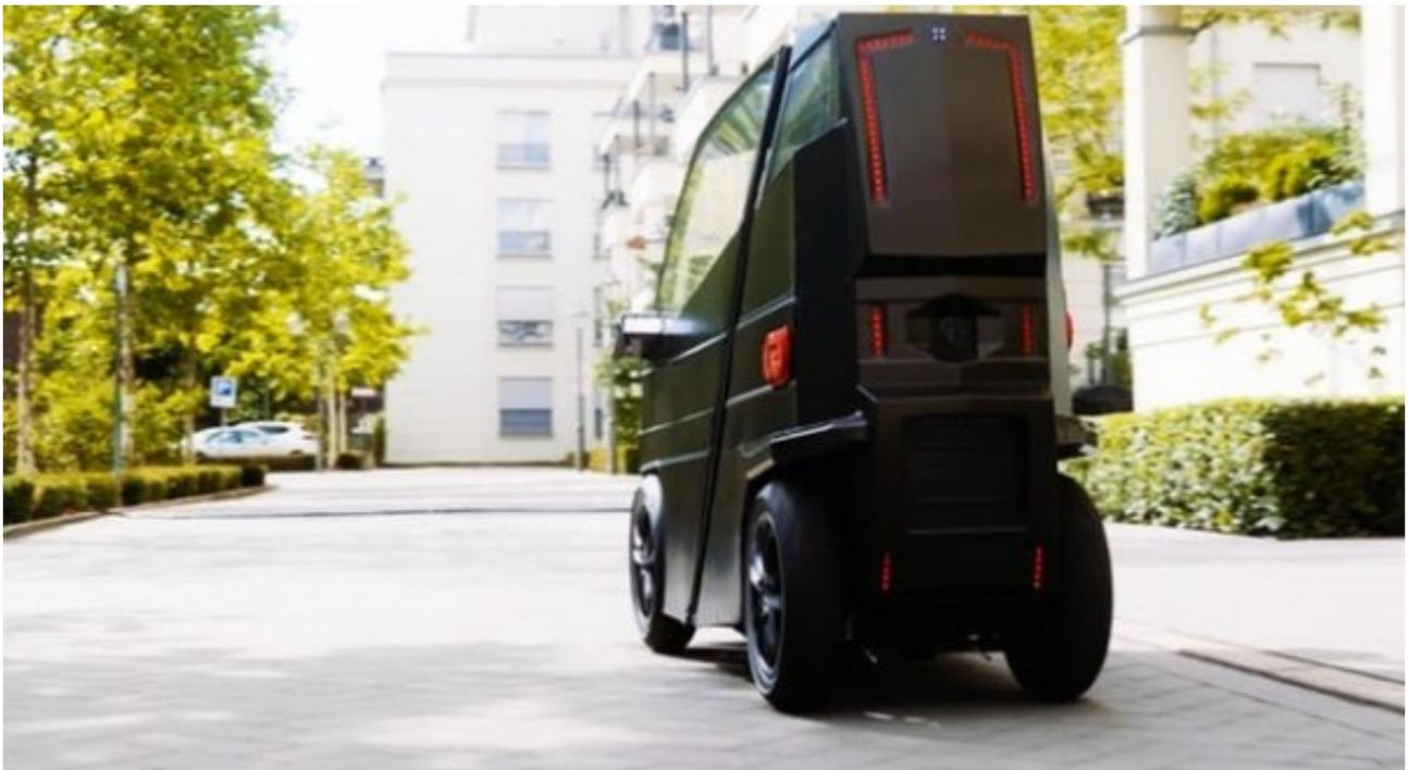
115千克的基本型号由48V锂离子电池组供电，充电3小时后续航里程可达60公里。40瓦的屋顶太阳能电池板将在汽车停放时为电池充电。iEV X最高时速为45公里/小时。145千克的iEV X +型号将搭载72V锂离子电池组，续航里程达12
