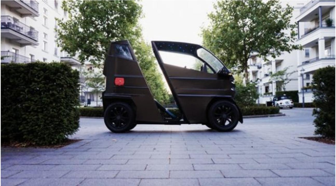
目前正在运行的原型形式中，iEV X在单乘客模式下仅为78厘米宽（30.7英寸）和160厘米长（63英寸）。当需要携带其他乘客时，汽车可以加长到190厘米（74.8英寸），允许折叠的第二个座位在驾驶员后面制造的。如果他们想要携带一些额外的货物，汽车可以进一步加长到220厘米（86.6英寸）。车辆的侧面在伸展时保持打开状态。
