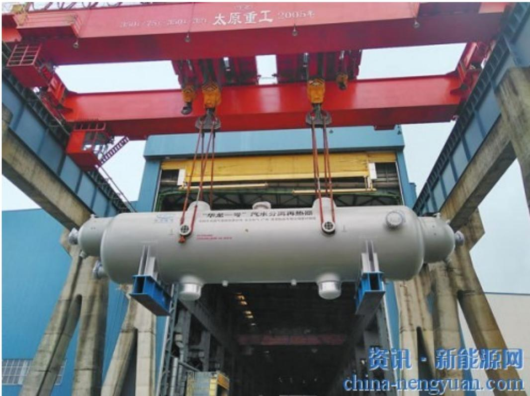
9月1日，在东方电气集团核电装备制造和出海口基地——东方电气（广州）重型机器有限公司（简称“东方重机”），福清5号机组“华龙一号”国内首台自主设计制造汽水分离再热器完工并发运。承担“华龙一号”首台汽水分离再热器研发和制造的东方重机，在汽水分离再热器性能、强度、结构等方面进行了全面研究，自主设计制造了新一代核电技术产品。攻克了管子管板焊接、壳体与椭圆封头焊接、再热器过渡筒节与椭圆封头焊接等道道难关，形成了我国核电装备国产化和核电“走出去”的核心竞争力，从而确保了国内首台“华龙一号”汽水分离再热器的成功设计制造。（陈庆友 翟莉 摄影报道）
