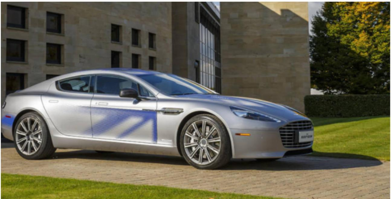
全新的Rapide E电动汽车行驶里程320公里。最高时速约250公里。加速成绩：4秒内从0到100，1.5秒内从80到115。两个后置电机，功率448kW，扭矩950Nm。后轮驱动和限滑差速器。在没有充满电的情况下也可以提供最高性能-这区别于特斯拉Model 3。空气动力学车轮可提高动力效率。电池系统由5600块锂离子电池组成。阿斯顿·马丁首席
