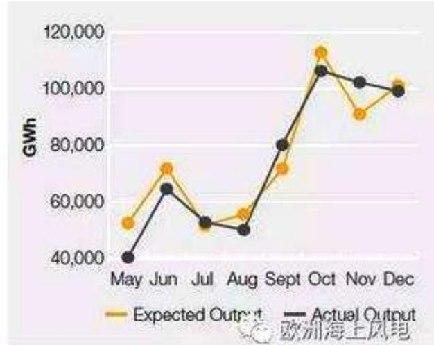
左图：2009年，英国某海上风电场投运，在投运后的第7个月，才达到与风速匹配的理论上的发电量，而之前6个月的发电量远低于理论值；
