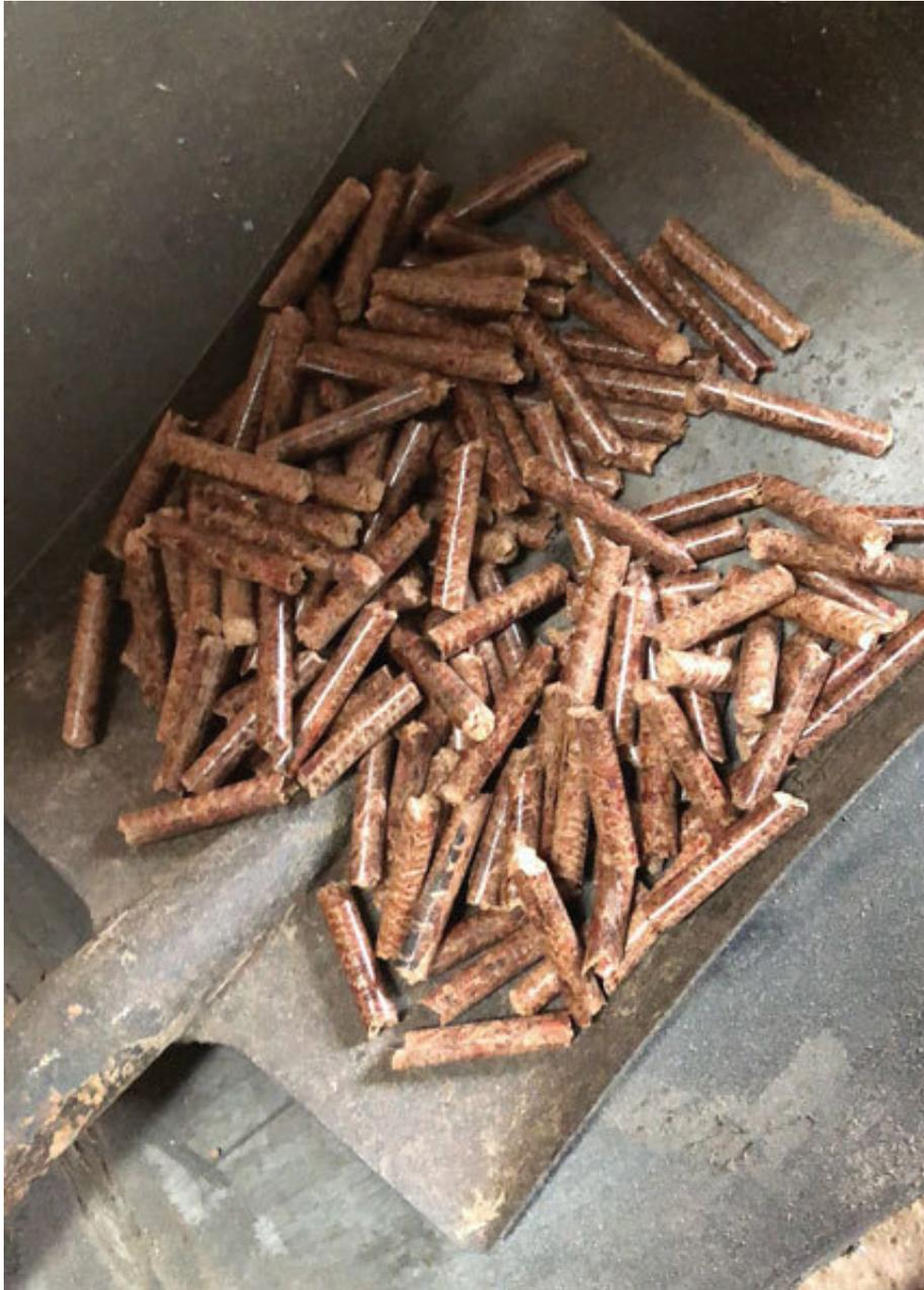
我们都知道如何处理松木和云杉等软木材，甚至是橡木和山毛榉等硬木。但是使用红木残渣原料，三分之二木屑和三分之一粉末的混合物呢？布氏硬度 $3.1\text{N}/\text{mm}^2$ ，红木几乎和橡木( $3.5\text{N}/\text{mm}^2$ )和山毛榉( $3.7\text{N}/\text{mm}^2$ )一样硬。
