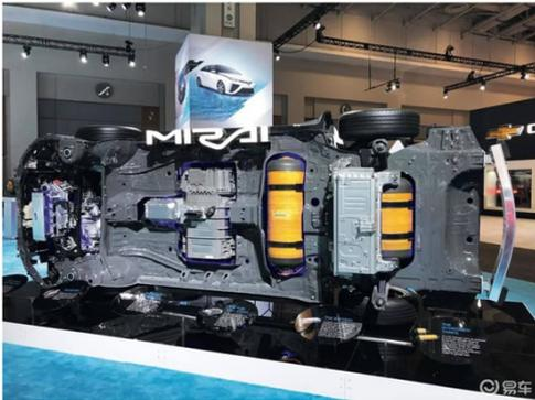
日本丰田 MIRAI 燃料电池车，车底装有 70MPa 加压储氢罐
