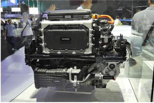
氢燃料电池和汽车电机整合
