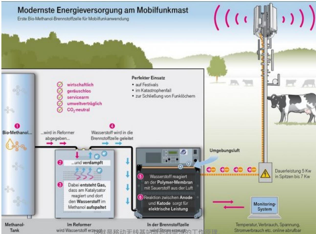
此外，燃料电池没有任何运动部件，如活塞或齿轮，可以避免噪音或振动。为了查看一切是否正常，电信技术人员不再需要在泥泞的草地上跋涉，因为他们可以通过远程监控系统来做维护。
