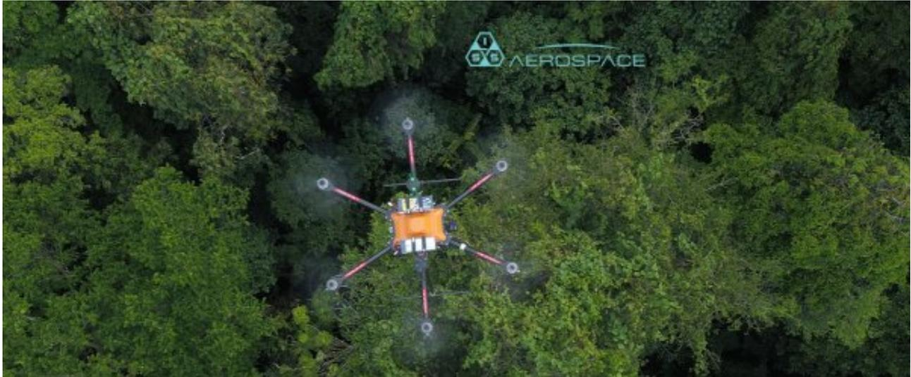
“我们打算制造一架7公斤以下的无人机，可以携带超过一个小时的有效载荷——这只能通过使用最新的燃料电池技术来实现。Intelligent Energy燃料电池和AMS钢瓶一起工作，使Sensus能够在空中停留更长时间，并携带更重的负载，为各种行业开辟了新的可能性。”
