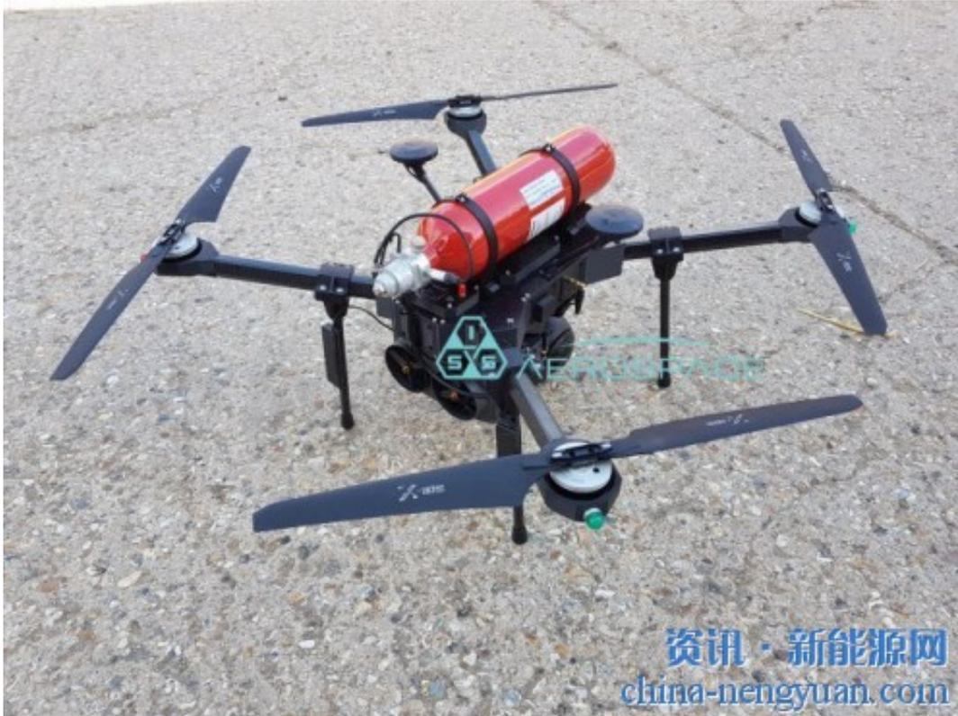
英国自主航空系统的领先开发商——ISS航空航天公司(ISS Aerospace)推出了Sensus，这是一款开创性的模块化氢燃料电池无人机(UAV)平台，配有来自AMS Composite Cylinders的超轻量碳复合气瓶。
