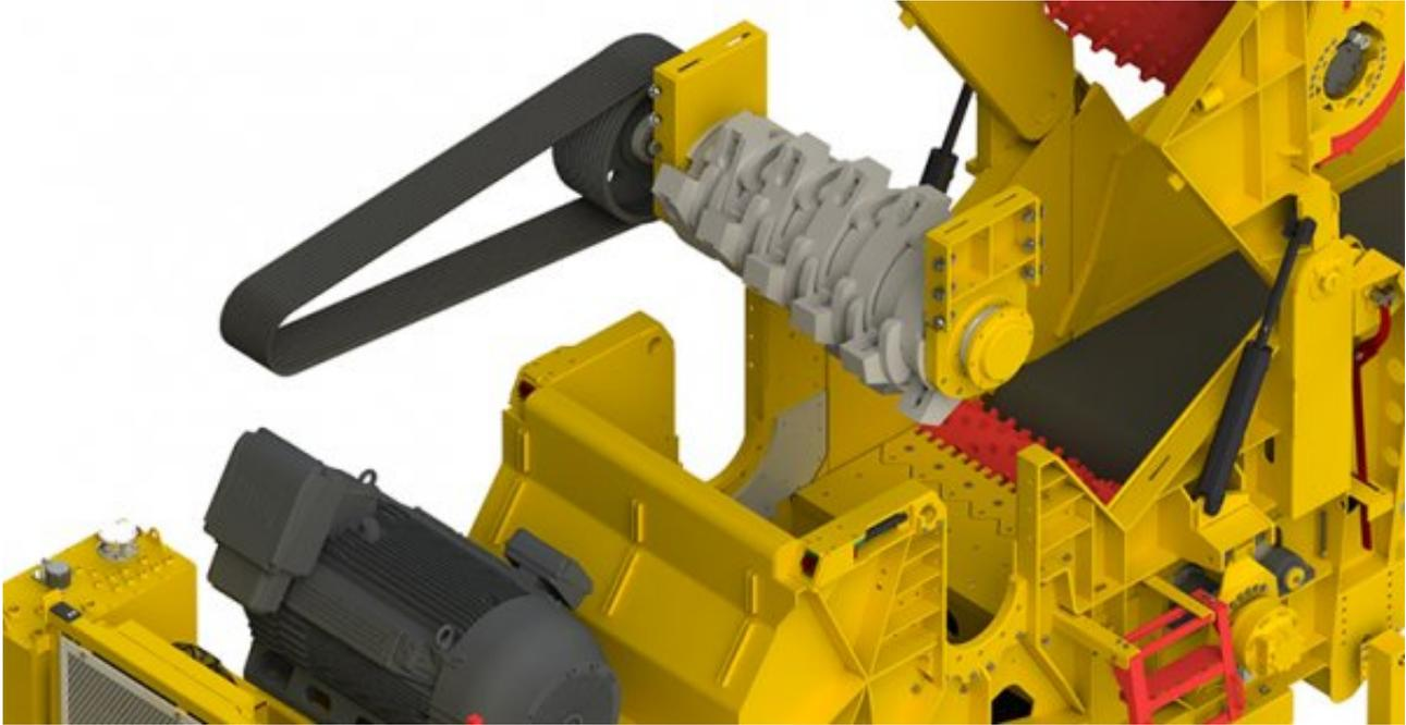
据根据CBI的说法，革命性的新型“盒式”翻盖设计使最终用户可以比同级别的其他破碎机更快地完全更换转子。操作员可以像以前一样，把从破碎到切屑的时间减少了一半，并可以接受各种材料。四个可互换的转子使这款卧式破碎机在不断变化的市场中保持其所需的多功能性（图片由CBI提供）。
