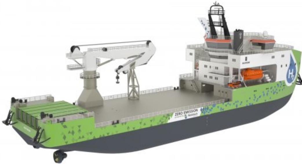
SX190 Zero Emission设计中使用的PEM燃料电池由集装箱压力容器中的氢气提供燃料，这是一种久经考验且易于获得的技术。这些储氢容器可以通过常规的容器装卸操作和设备进行装卸，因此无需昂贵的燃料加注基础设施，并提供了全球范围的操作灵活性。
