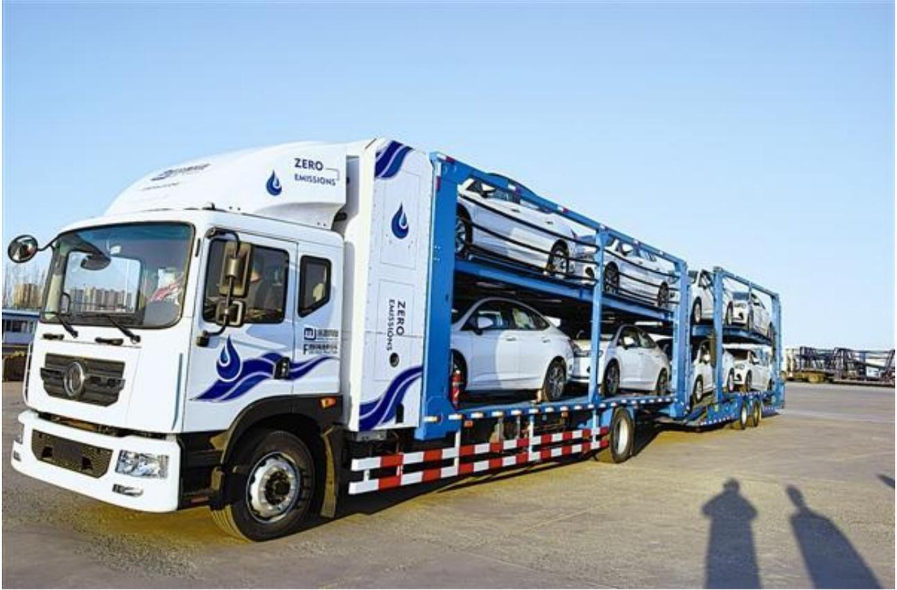
世界首款燃料电池重型轿车运输车，满载最大可达36吨，续航里程超过800公里。昨日，由大连自贸片区企业洺源科技（大连）有限公司和大连新源动力股份有限公司合作开发的首款18吨至36吨级燃料电池重卡平台成功研制，基于此平台开发的世界首款燃料电池重型轿车运输车率先进行实地场景路试。
