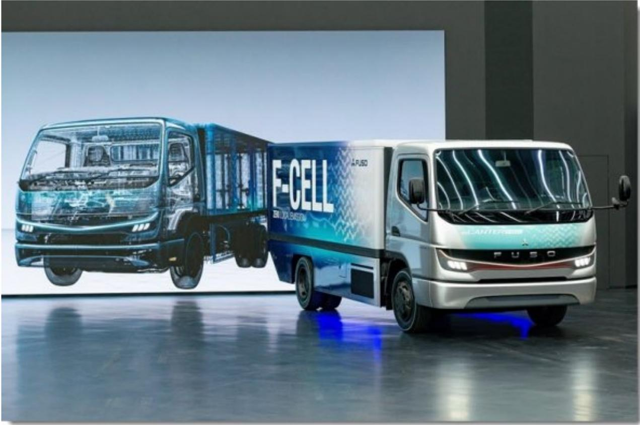
在2019年东京车展上，MFTBC推出了Vision F-CELL，一款轻型燃料电池概念卡车。车辆已经被进一步细化成概念eCanter F-CELL，一种轻型卡车，今天在川崎展出。这种汽车利用高能量密度的高压氢，可以行驶300公里，大大缩短了加油时间，不到10分钟即可完成燃料补充，从而最大限度地延长了客户的行驶时间。
