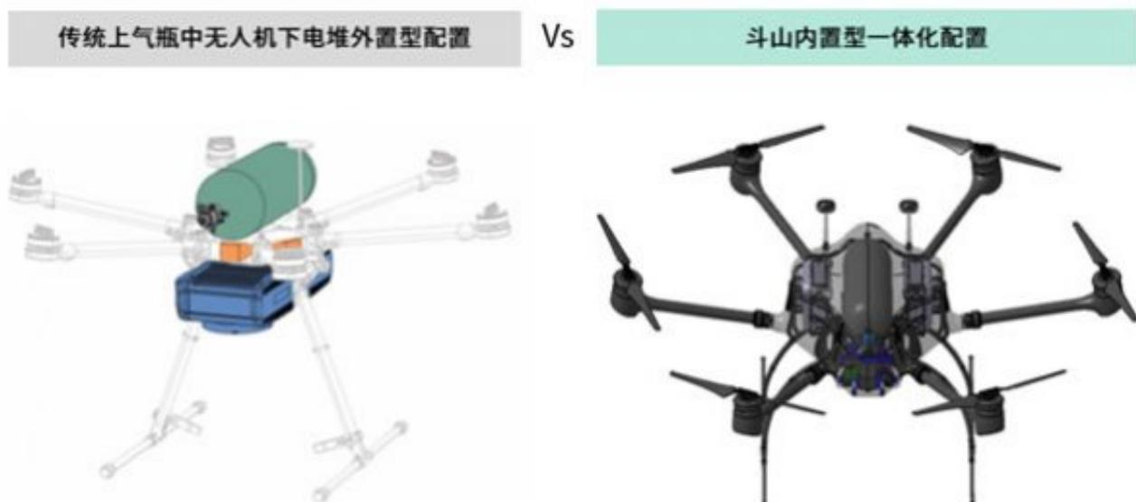
传统的氢动力无人机在结构上大多使用“上气瓶，中无人机，下电堆”的结构，并一味追求减少重量增加续航时间，所有燃料电池电器系统及氢气供应配件裸露在外，使用过程中操作不便，且在飞行过程中遇到以外情况时无法保证飞行安全。
