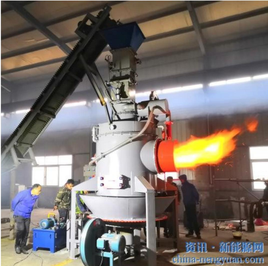
近日，海琦环保的老客户河北某公司承接的制药厂中药渣处理项目，经综合考察比对试验发现使用，海琦熔融热解炉系统处理的模式简洁高效即充分利用了该废料残余的热能用以自身的干燥与熔融热解，又将多余能源产生蒸汽效益一举多得，效果明显。
