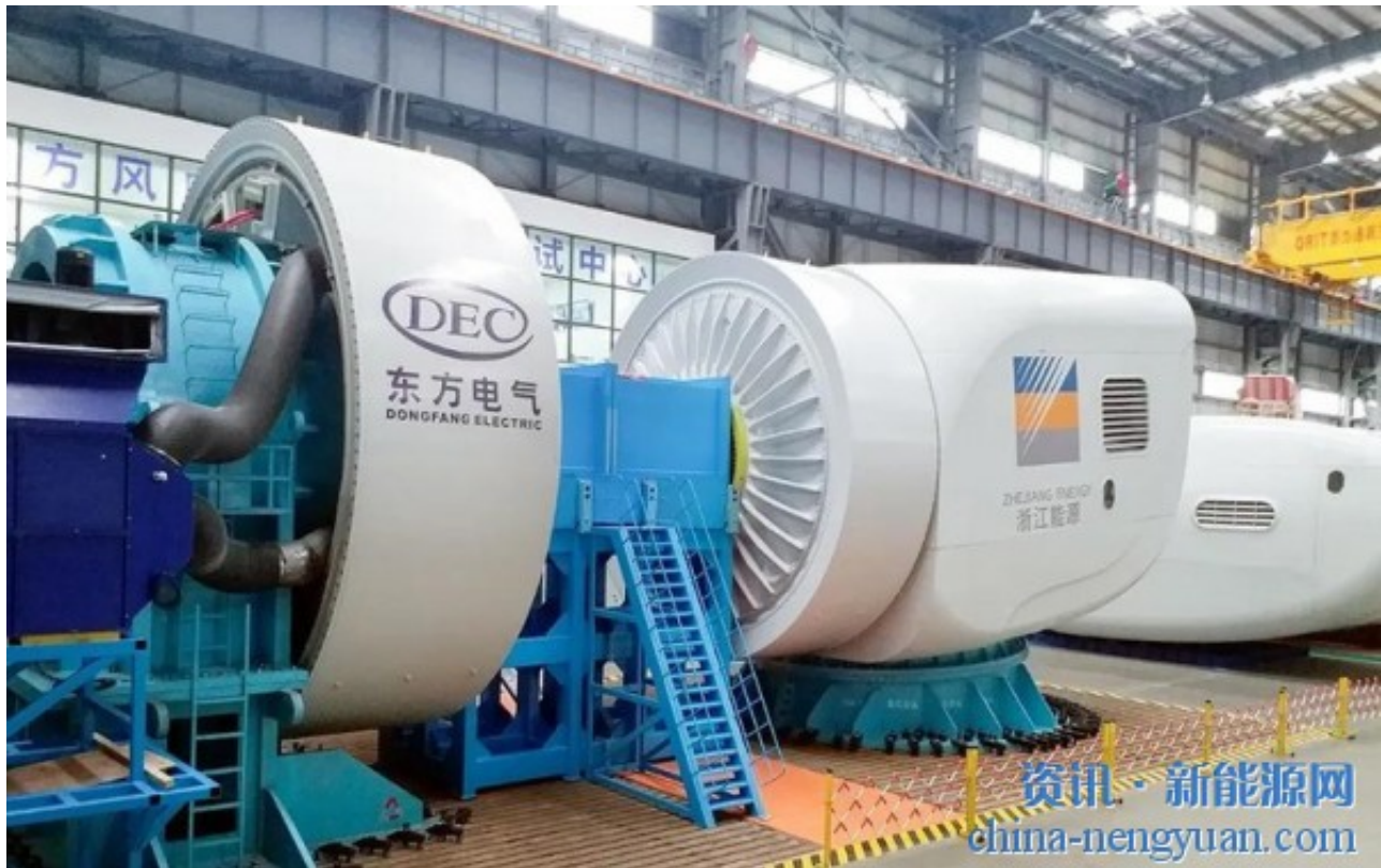
装配DEW-D7000-186型海上风力发电机。来源：东方电气集团
