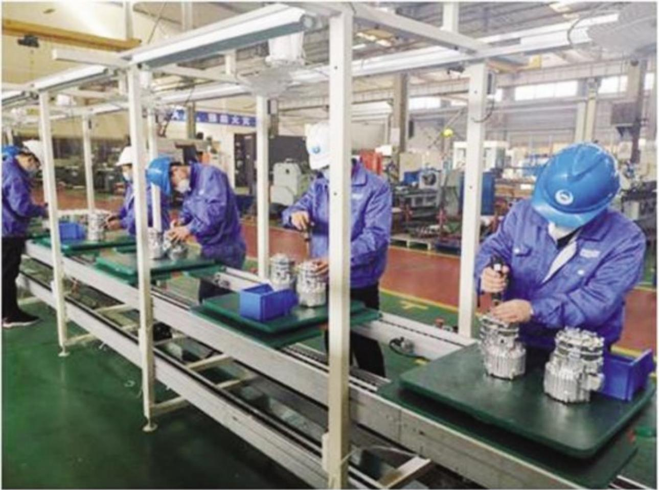
氢气循环泵装配生产线
