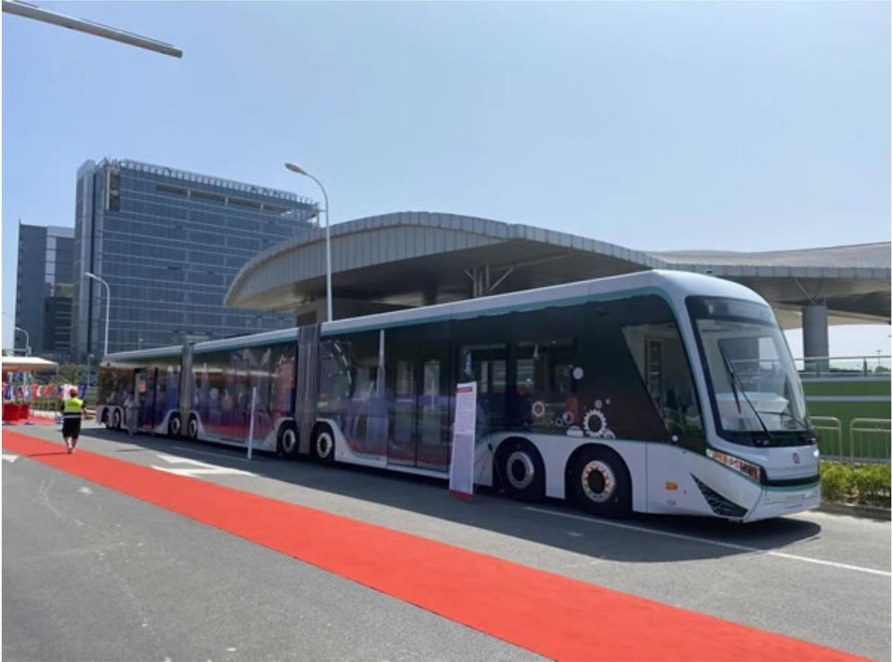
T1示范线车辆采用数字轨道胶轮电车（DRT）制式，是全国第一条DRT数字轨道电车。DRT系统是针对城市公共交通出行领域新场景新需求新问题研发出来的一款产品，以技术的突破来杜绝建设过程当中大拆大建工程。其他制式电车要么地面铺设轨道要么空中架设滑触线，通过GPS或视频识别路线。DRT数字轨道捷运系统通过地面磁钉与车实现物理识别，地上每隔一定距离埋磁钉，磁钉可以做数字编码，路线、车速等参数提前设定好，这样所有磁钉构成一个电子地图，车就相当于在电子地图上行驶。
