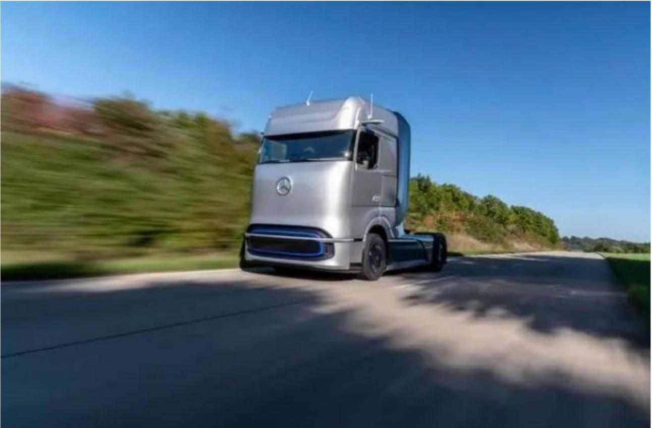
据悉，该概念车配备了300 kW的燃料电池系统和电池，可以暂时提供额外的400 kW功率。该电池的容量为70 kWh，旨在“为燃料电池提供情景支持，例如在加速或满载上坡时的峰值负载期间。”而在预生产卡车中，将有两个电动机，每个电动机的峰值输出为443 hp（330 kW / 449 PS）和1,527 lb-ft（2,071 Nm）的扭矩。但是，它们的连续额定功率较低，为308 hp（230 kW / 312 PS）和1,163 lb-ft（1577 Nm）。
