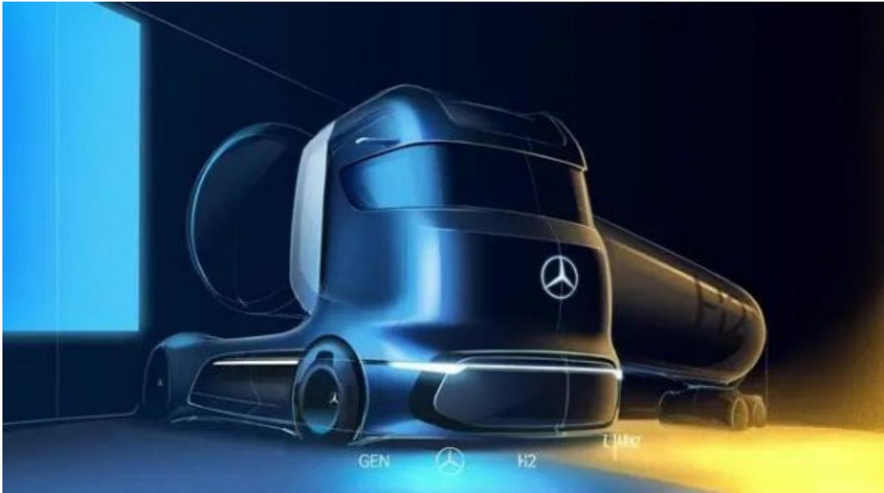
在牵引力、续航里程和性能方面，戴姆勒卡车研发工程师均以传统车型梅赛德斯-奔驰阿克托斯（Actros）长途卡车为标准设计GenH2卡车，例如，GenH2量产版本的车辆总质量将为40吨，载质量将为25吨。GenH2概念卡车的核心是强大的燃料电池系统以及两个独特的液氢罐，这让重载荷和长续航成为可能。
